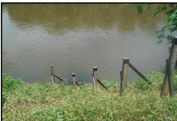
Figura 4.33 – Ponto 3, réguas de medição de nível no Parque Municipal.
