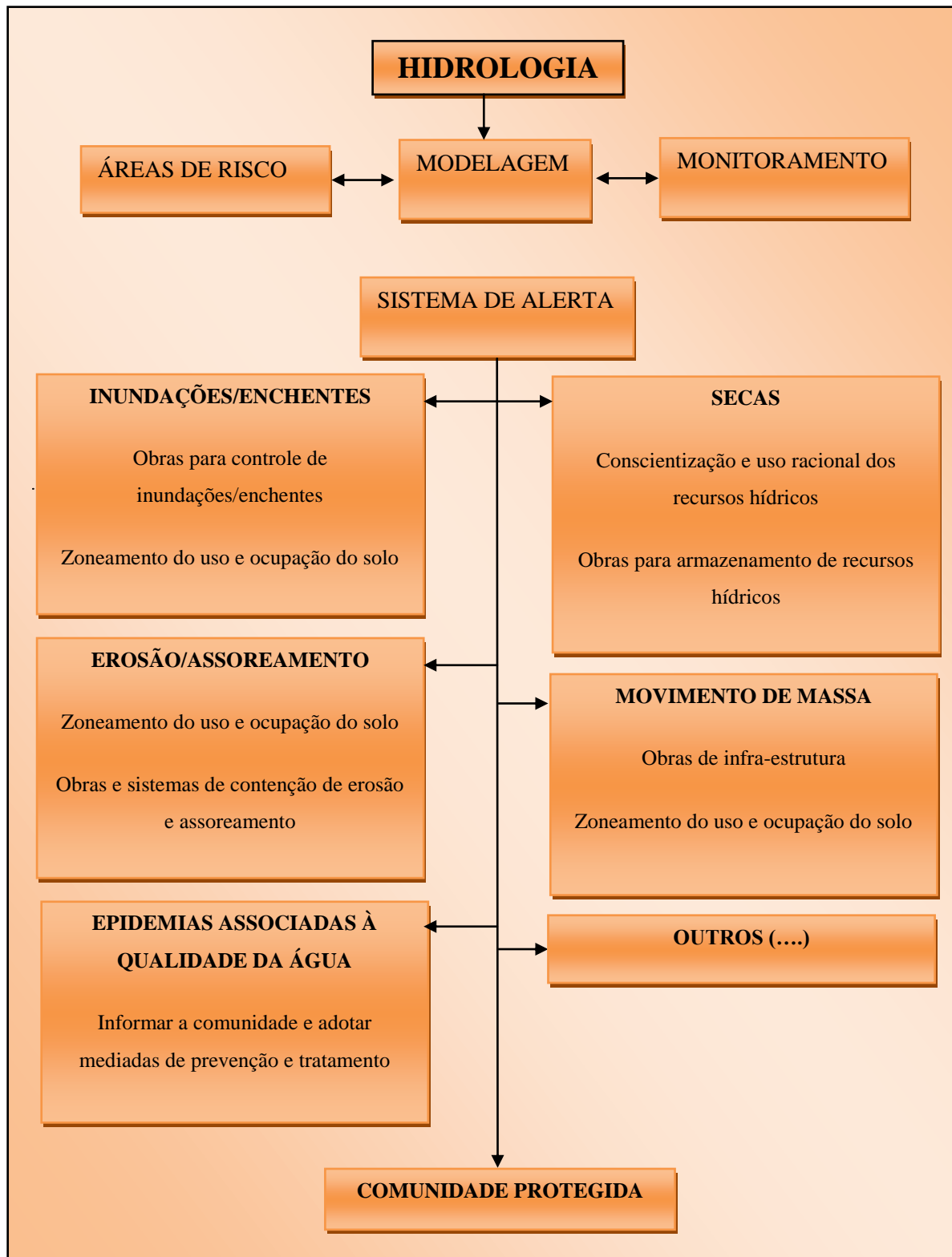
Figura 2.16 – Fluxograma do papel da Hidrologia na prevenção e mitigação dos desastres. Fonte: TUCCI (2005)
